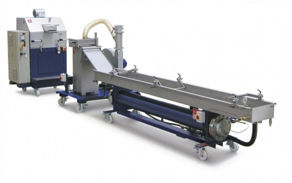
Obr. 15 Strojní zařízení pro studenou granulaci – vodní lázeň, granulátor.
