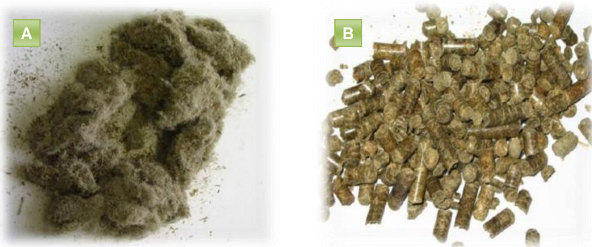
Obr. 10 Transformace jemné frakce konopných vláken (A) na pelety (B).
