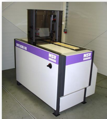
Obr. 36 Zařízení pro plazmovou modifikaci technologií DBD.
