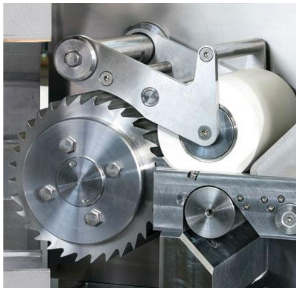
Obr. 16 Detail granulátoru (podavací a opěrný válec, nožová hlava).
