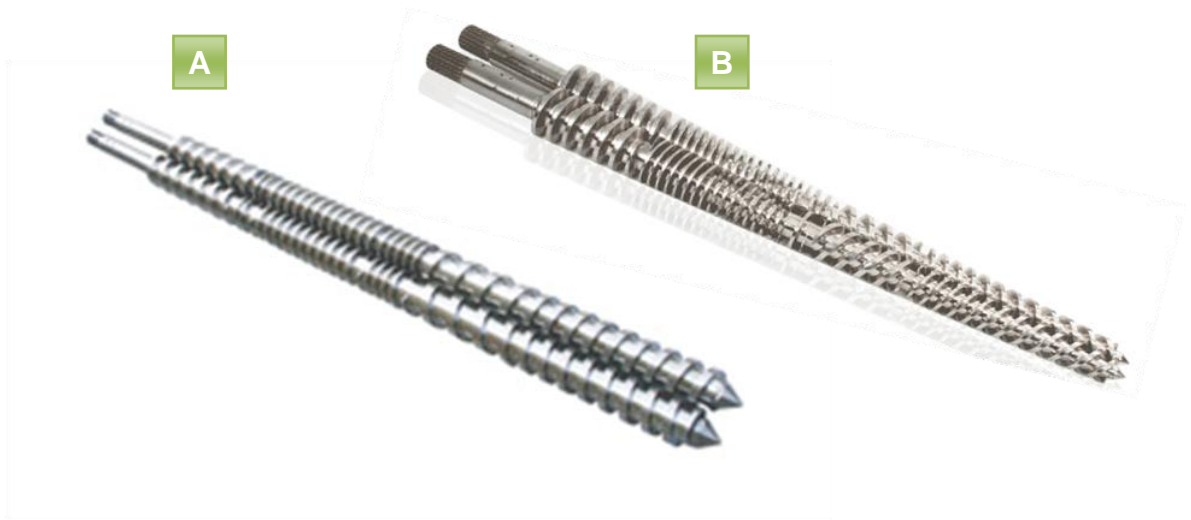
Obr. 11 Kompaundační šneky paralelní (A) a kónické (B).
