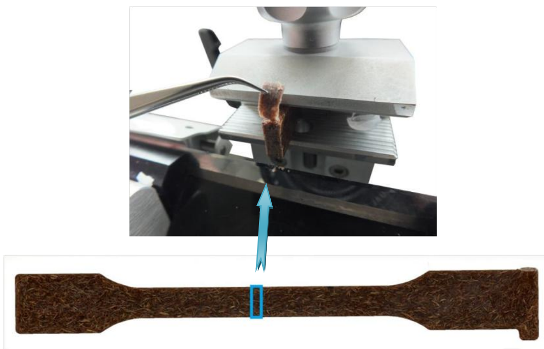
Obr. 40 Zkušební těleso biokompozitu PLA + 20 hm. % kokosových vláken s vyznačeným místem odběru vzorku pomocí mikrotomu.
