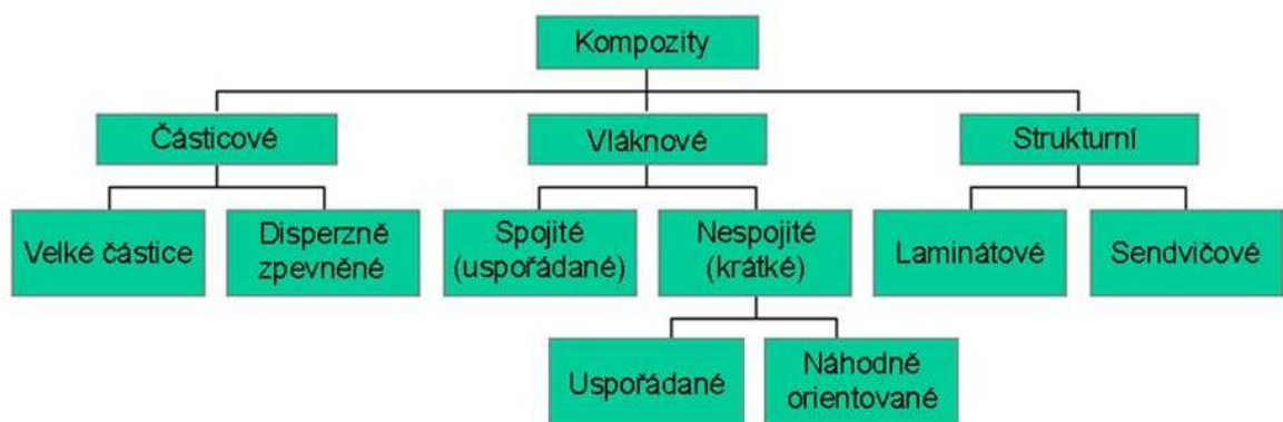
Obr. 1 Rozdělení kompozitů podle typu a uspořádání výztuže [4]
