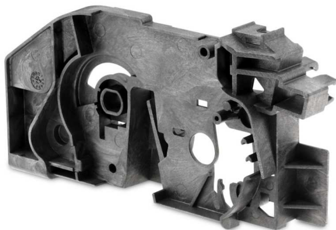
Obr. 12 Vzduchové šmouhy na povrchu vstřikovaného dílu technologií MuCell [16]
