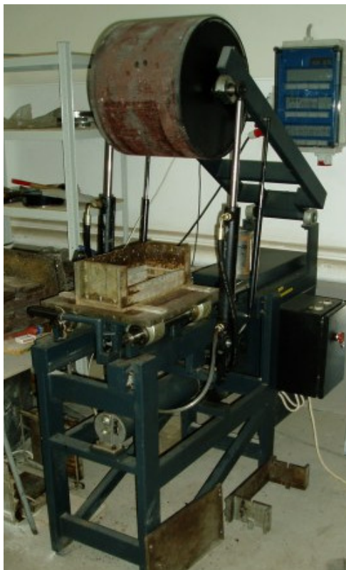
Obrázek 23 – Lamelový zhutňovač pro hutnění desek
