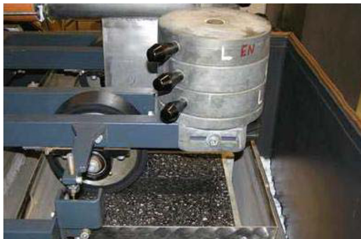
Obrázek 24 – Deska upevněná ve formě umístěné ve zkušebním zařízení [15]
