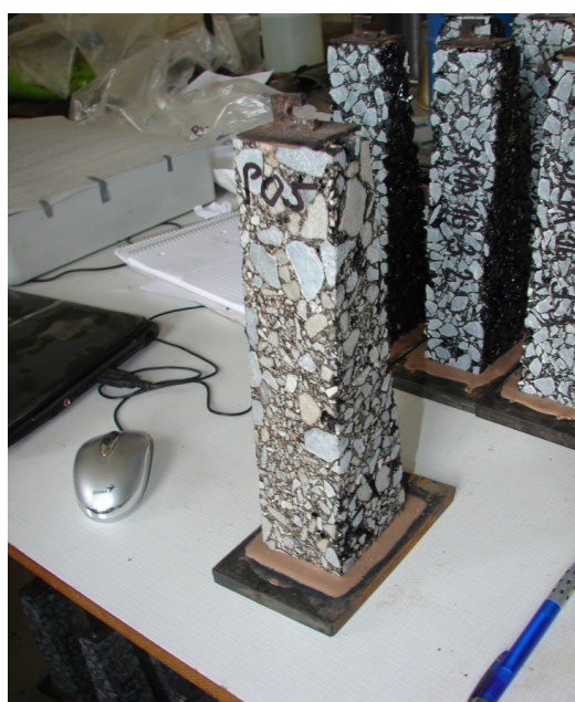
Obrázek 27 – Detail trapezoidu připraveného ke zkoušení
