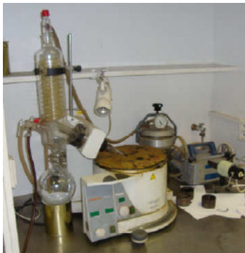
Obrázek 21 – Příklad přístroje pro zpětnou destilaci asfaltového pojiva
