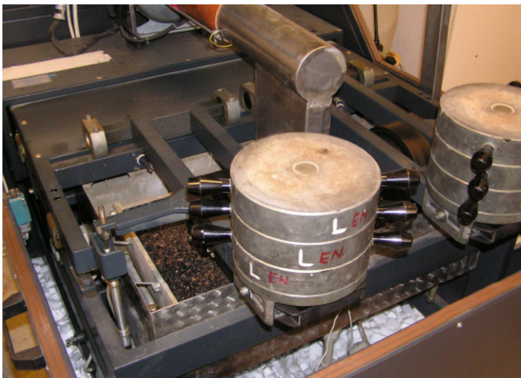
Obrázek 9 – Zkušební zařízení – vyjížděč kolejí [13]
