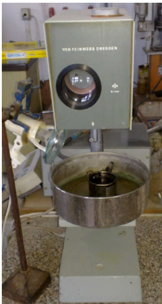
Obrázek 17 – Zařízení pro měření penetrace ( penetrometr)
