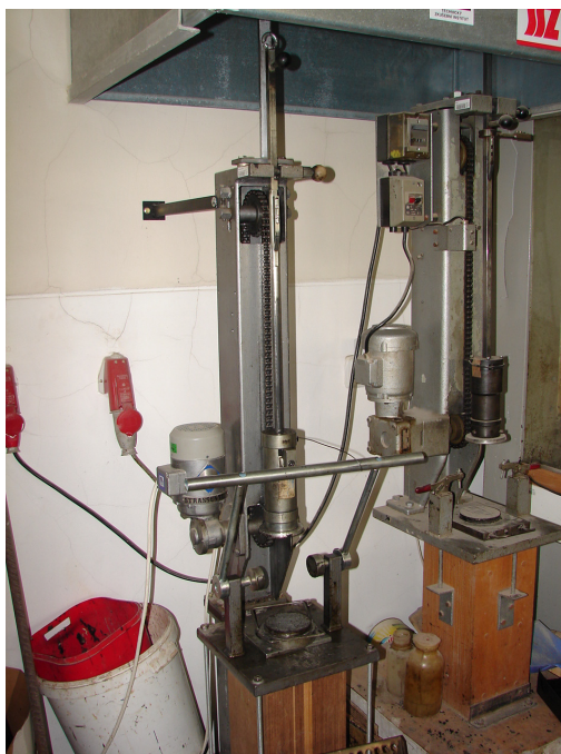
Obrázek 22 – Marshallův zhutňovač v silniční laboratoři
