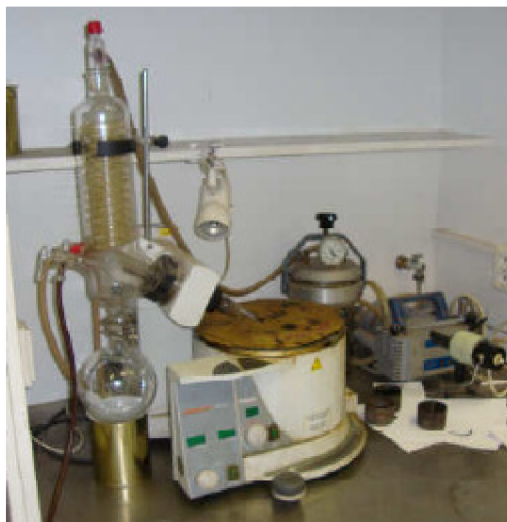
Obrázek 21 – Příklad přístroje pro zpětnou destilaci asfaltového pojiva
