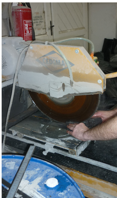
Obrázek 25 – Kotoučová pila k rozřezání desek na trapezoidy a trámečky
