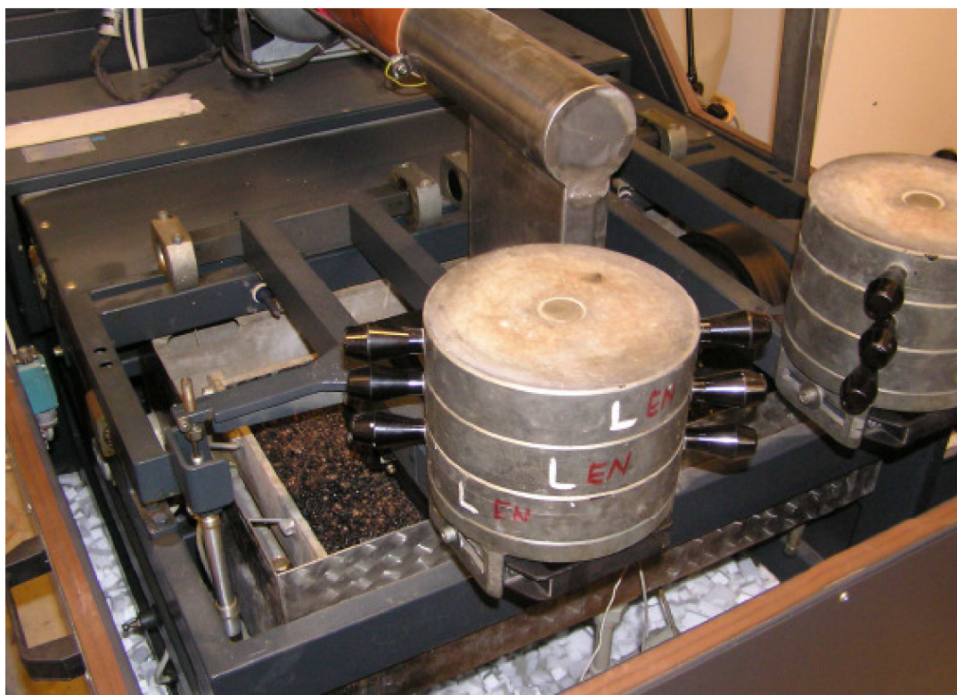
Obrázek 9 – Zkušební zařízení – vyjížděč kolejí [13]
