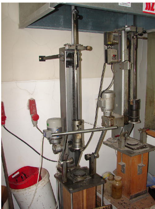
Obrázek 22 – Marshallův zhutňovač v silniční laboratoři
