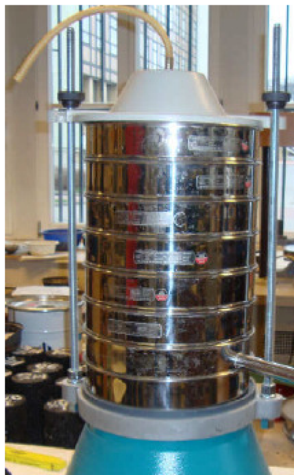
Obrázek 19 – Zařízení pro stanovení zrnitosti kameniva
