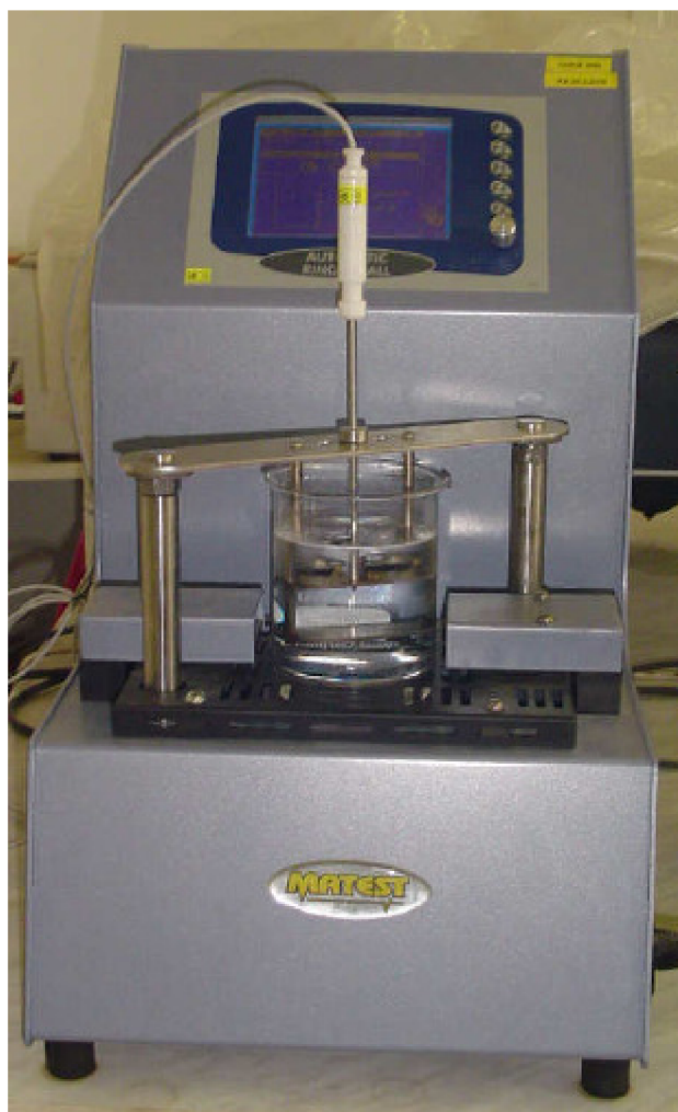
Obrázek 18 – Zkušební zařízení pro zkoušení bodu měknutí asfaltových pojiv
