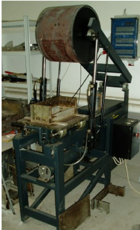
Obrázek 23 – Lamelový zhutňovač pro hutnění desek
