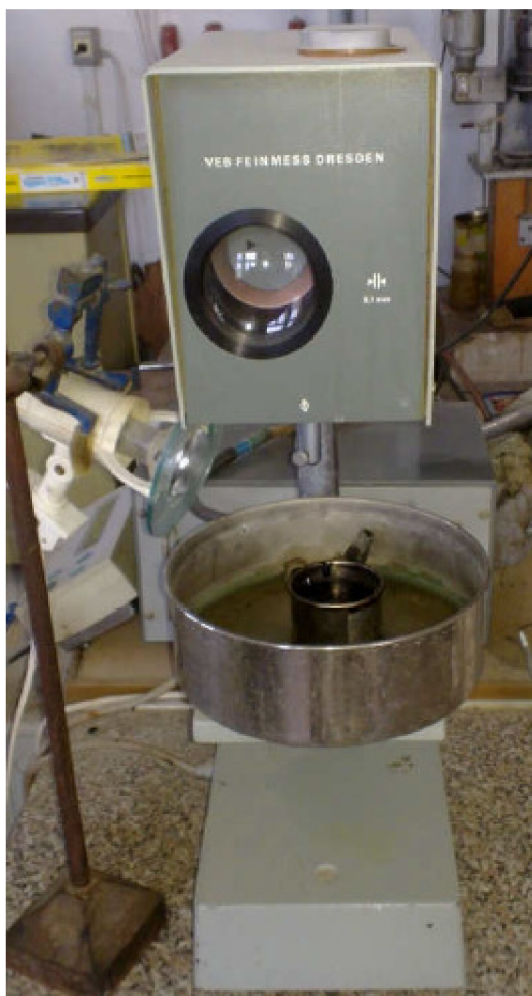
Obrázek 17 – Zařízení pro měření penetrace ( penetrometr)
