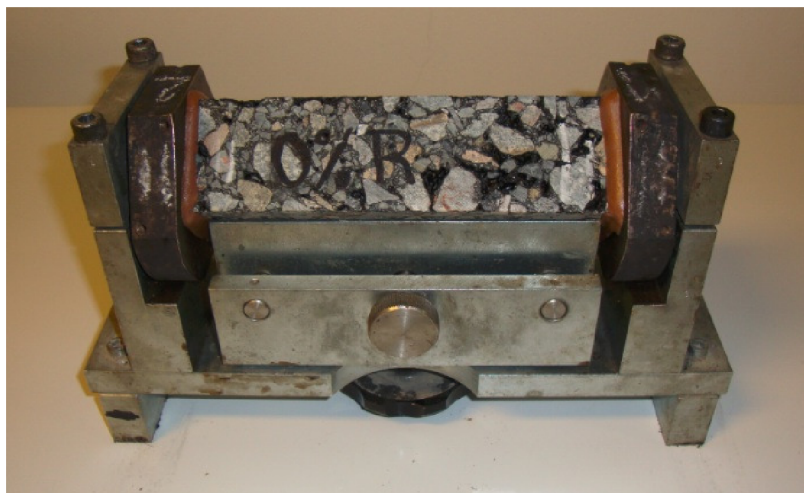
Obrázek 28 – Příklad zkušebního tělesa přilepeného k čelistem a upnutého v centrovacím zařízení [15]
