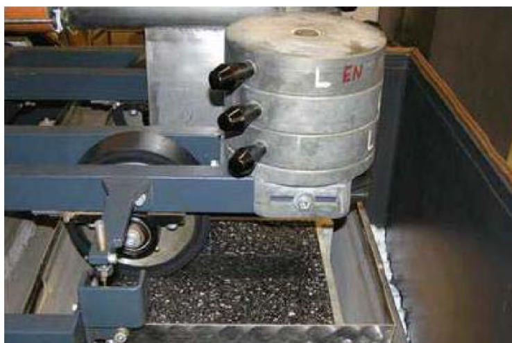
Obrázek 24 – Deska upevněná ve formě umístěná ve zkušebním zařízení [15]
