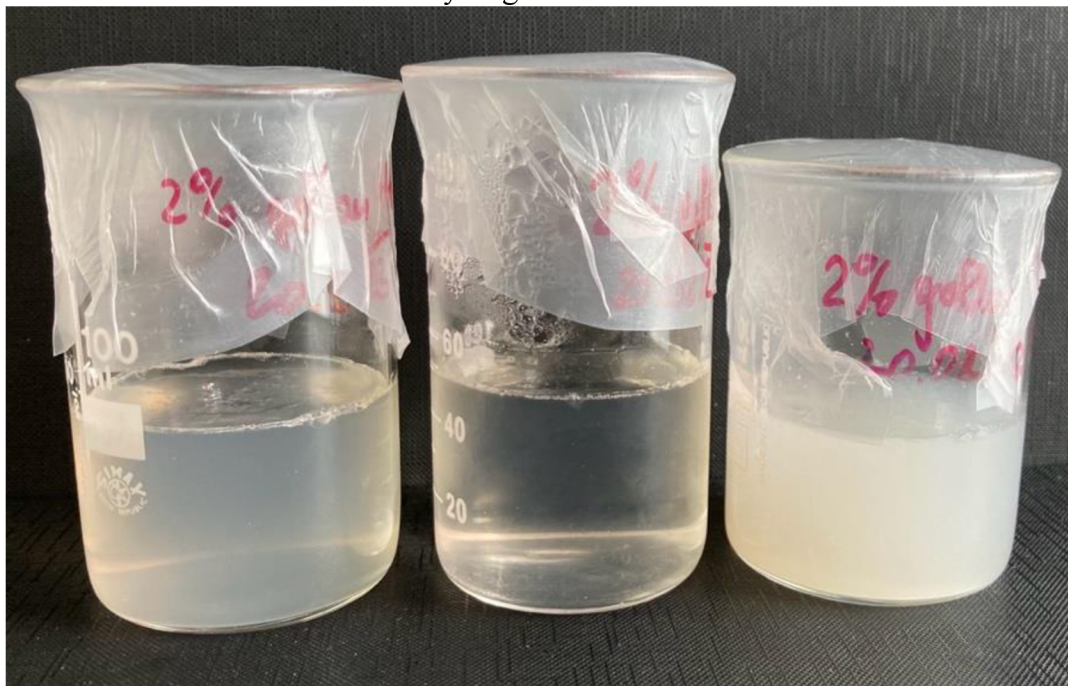
Obrázek 7: Srovnání (zleva:) 2% gellanového hydrogelu s přidavkem PO částic, 2% čistého Gellanu a 2% hydrogelu s přidavkem IPA částic
