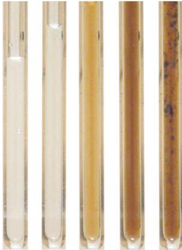
Obr. 2.4 Obsah kapiláry v různých fázích procesu hydrotermální karbonizace glukózy [33]
