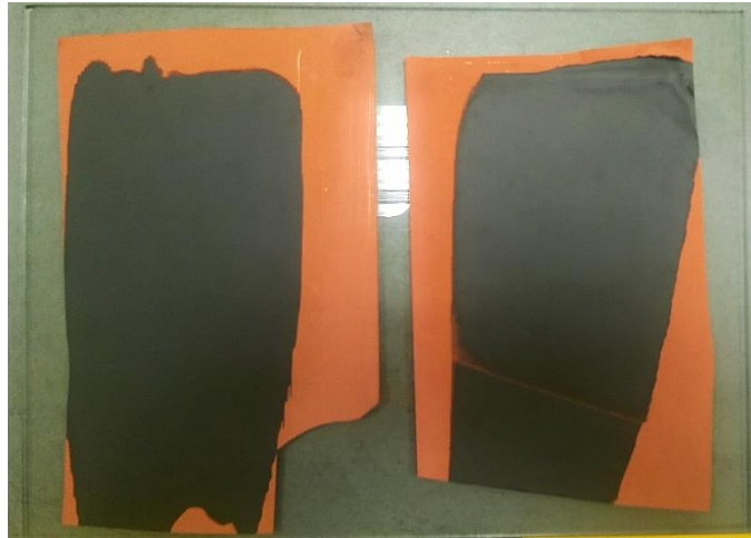
Obr. 39: Vysušené vrstvy deponovaného elektrodového materiálu, vlevo s tloušťkou h_{dep}=60 \mu\text{m} , h_{dep}=100 \mu\text{m} vpravo, jejichž tloušťka tímto klesla na h_{nelis} .
