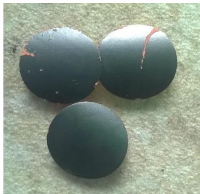
Obr. 42: Některé elektrody s odhaleným měděným povrchem po procesu lisování o tloušťkách vrstev 150 \mu\text{m} . Pod nimi je stejný kus bez defektu, který byl připraven rovnoměrnějšími přechody k finálnímu plis.
