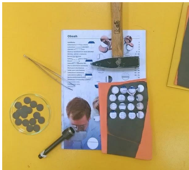
Obr. 40: Pomůcky při vysekávání elektrod. Ideální je jeden úder kladivem.
