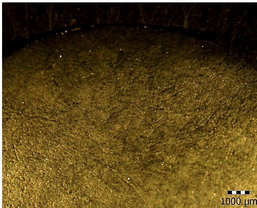
Obr. 50: Zvrásnění povrchu a cizí mikročástice (60 μm, 1500 kg·cm -2 )
