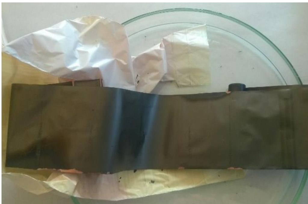
Obr. 47: Záporná grafitová elektroda a elektrolyt komerčního akumulátoru Panasonic 18650
