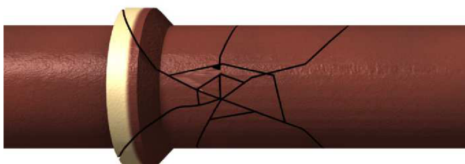
Obr. 16: Prasklina na potrubí vzniklá v bodě [29]
