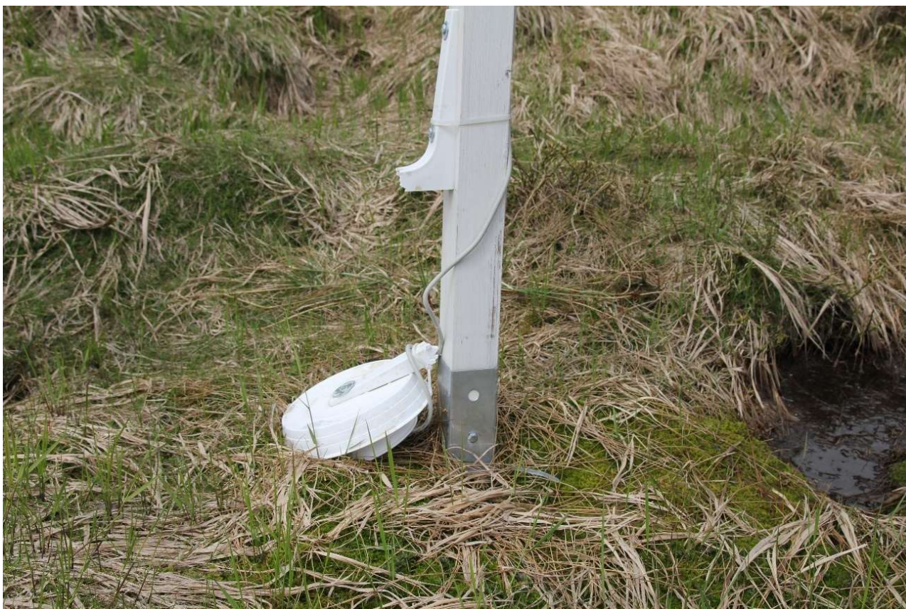
Obrázek 13 – Ulomený držák čidla
