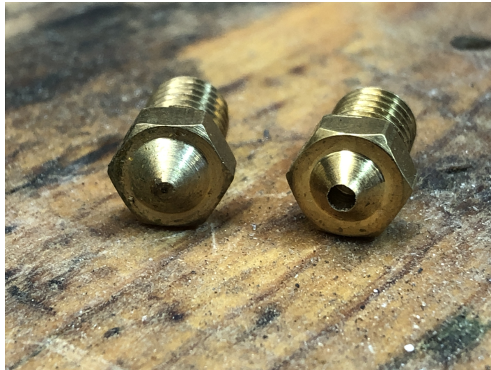
Obrázek 12: Porovnání nevyvrtané a vyvrtané (vpravo) trysky
