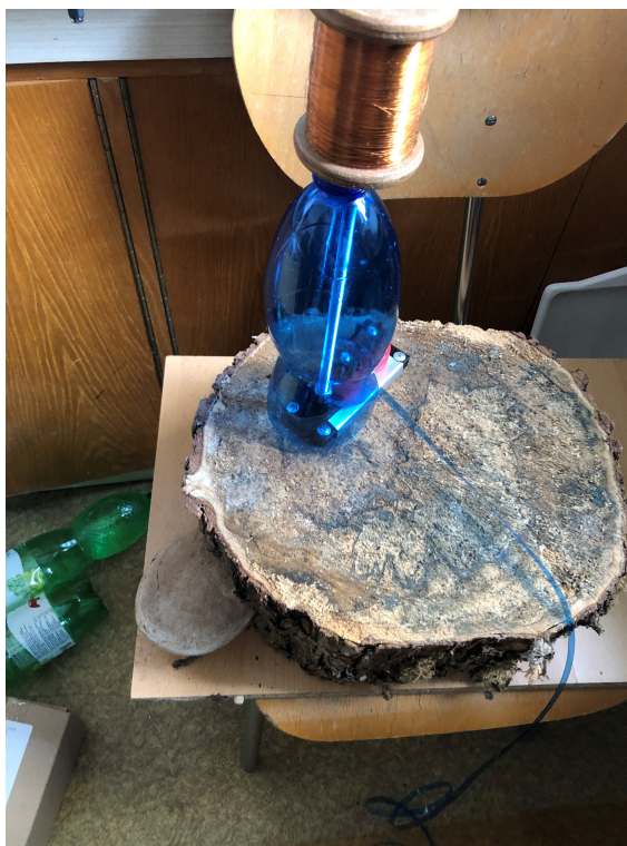
Obrázek 40: První pokusy řezání PET lahve bez jejího vyhlazení
