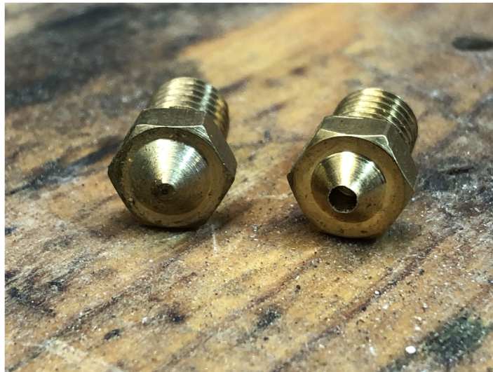
Obrázek 12: Porovnání nevyvrtané a vyvrtané (vpravo) trysky
