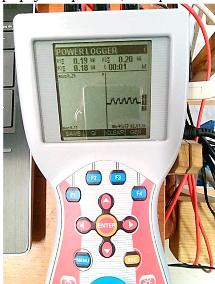
Obr. 13: Ukázka principu záznamu přístroje Metrel Power
