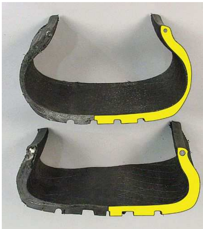
Obr. 9 Rozdíl mezi konvenční (nahore) a Run-Flat pneumatikou (dole)
