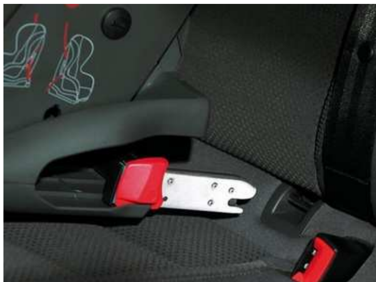
Obr. 20 Systém kotvení ISOFIX, zdroj:
