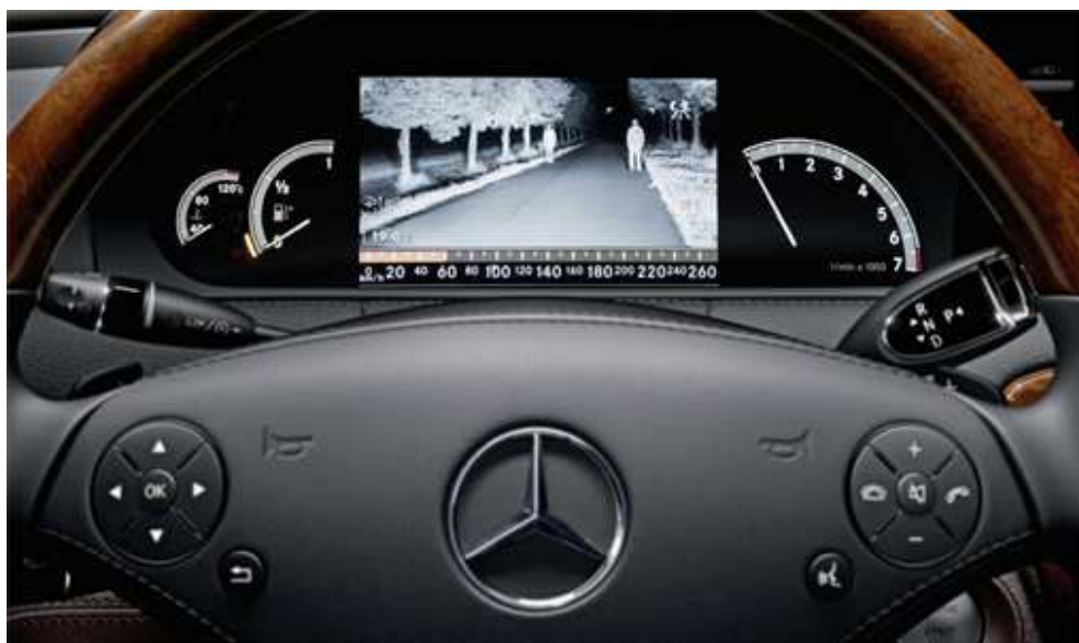
Obr. 8 Systém nočního vidění u vozu Mercedes-Benz [11]
