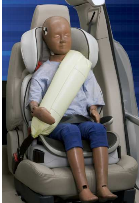
Obr. 18 Nafukovací bezpečnostní pás v kombinaci s dětskou autosedačkou zdroj: http://www.zavolantem.cz/ford-predstavil-nafukovaci-bezpecnostni-pasy
