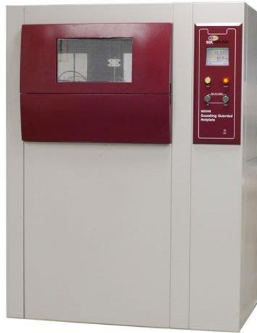
Obrázek 11: Přístroj SGHP společnosti SDL Atlas [26]
