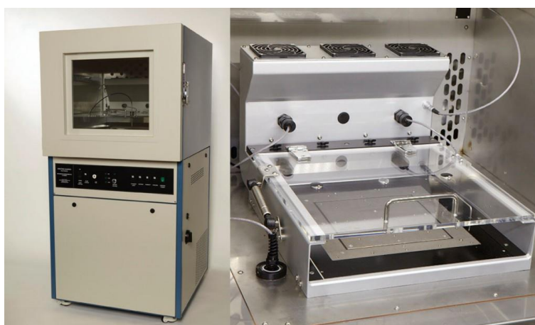
Obrázek 5: Ukázka přístroje SGHP – vyhřívané destičky [27]
