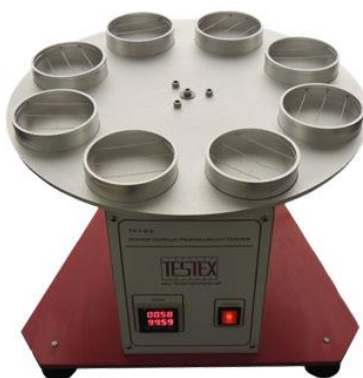
Obrázek 9: Ukázka zařízení pro měření propustnosti vodních par [27]
