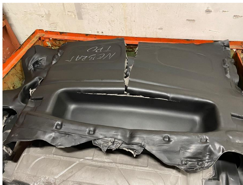
Obrázek 2 Příklad nepovedeného výrobku – krytu motoru
