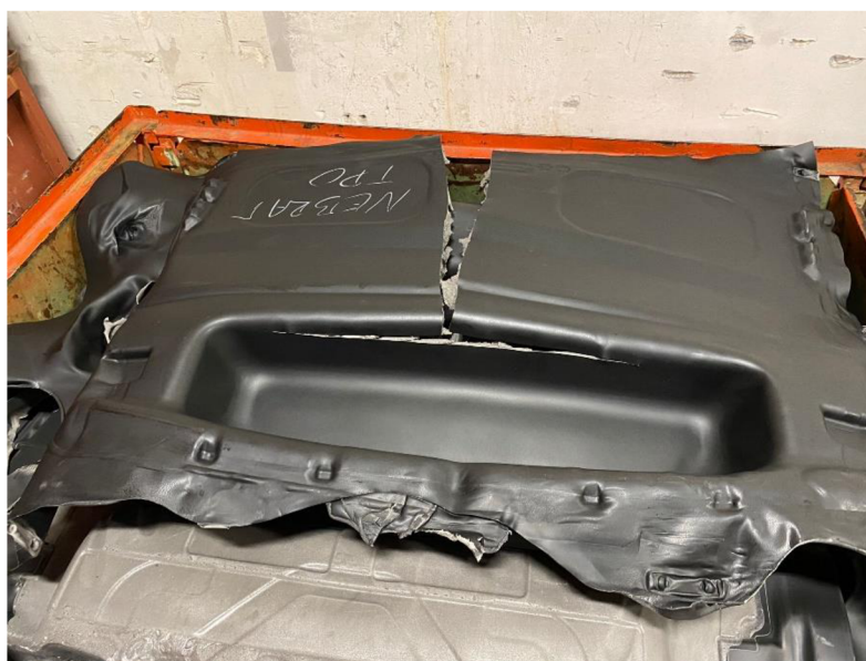
Obrázek 2 Příklad nepovedeného výrobku – krytu motoru
