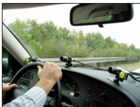
Obr. 30: Instalace systému Smart Eye Pro 5.10 ve vozidle [75]
