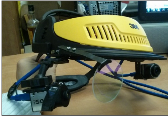
Obr. 33: Vlastní konstrukce eyetrackeru [75]
