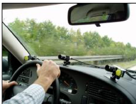
Obr. 30: Instalace systému Smart Eye Pro 5.10 ve vozidle [75]
