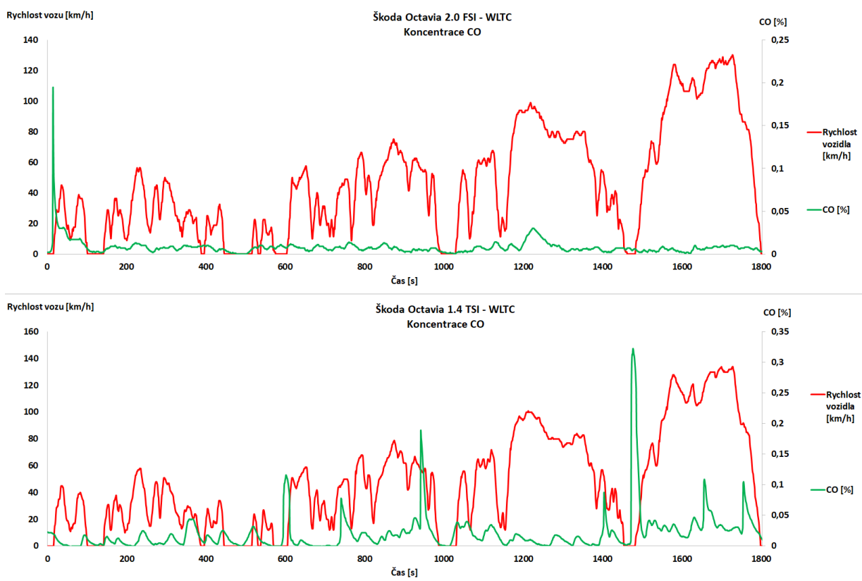
Obr. 35 Průběh koncentrací emisí oxidu uhelnatého při jízdním cyklu WLTC
