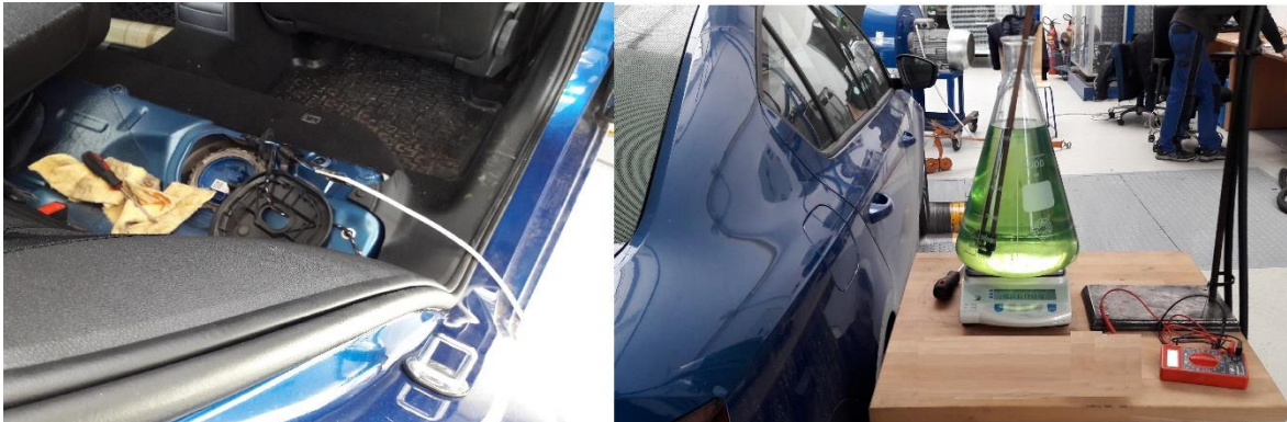
Obr. 31 Příprava externí palivové soustavy
