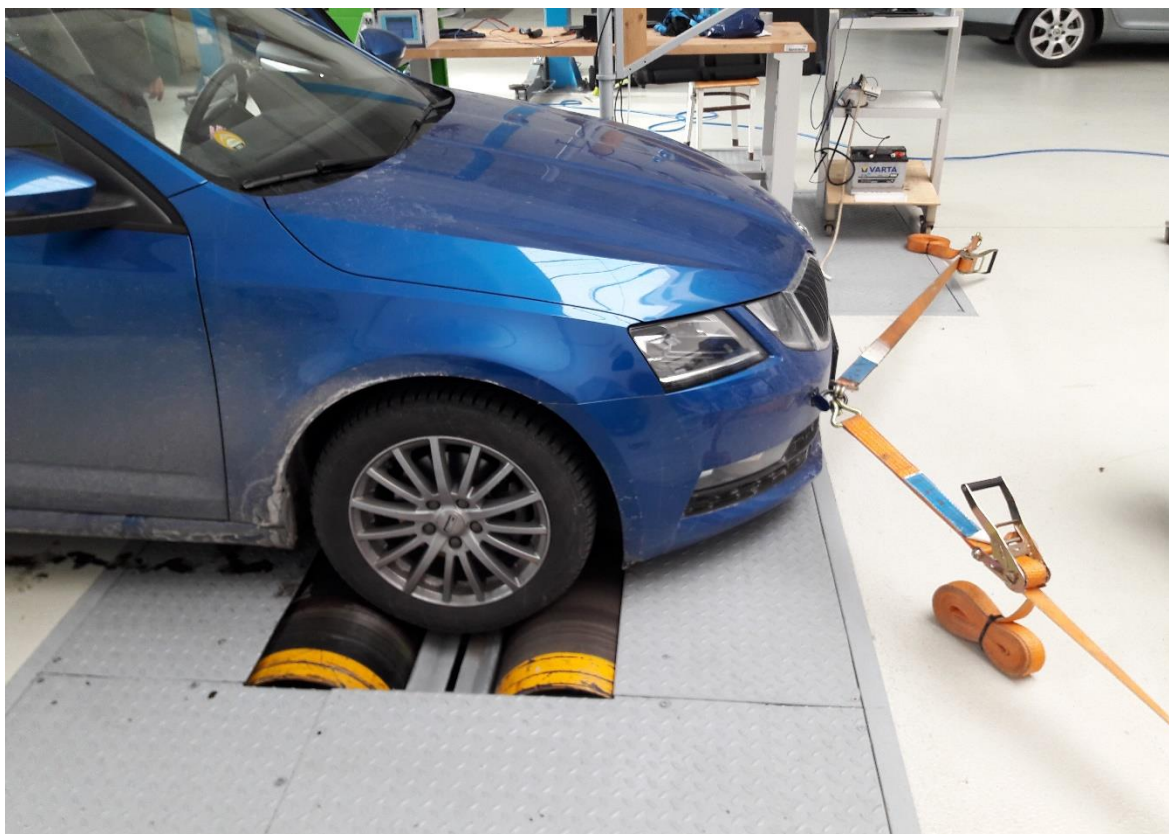
Obr. 30 Připevnění vozidla k válcům zkušebny
