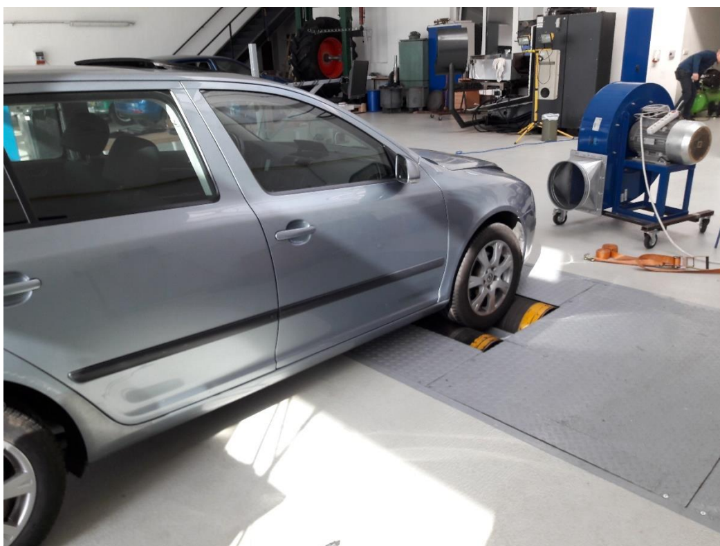
Obr.22 Válcový dynamometr – technické prostory katedry Vozidel a pozemní dopravy
