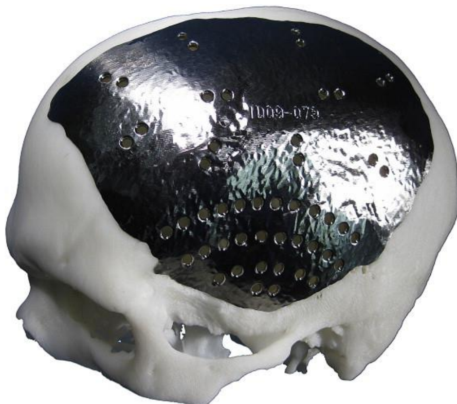
Obr. 5.1: Příklad personalizovaného implantátu ze slitiny titanu [28]
