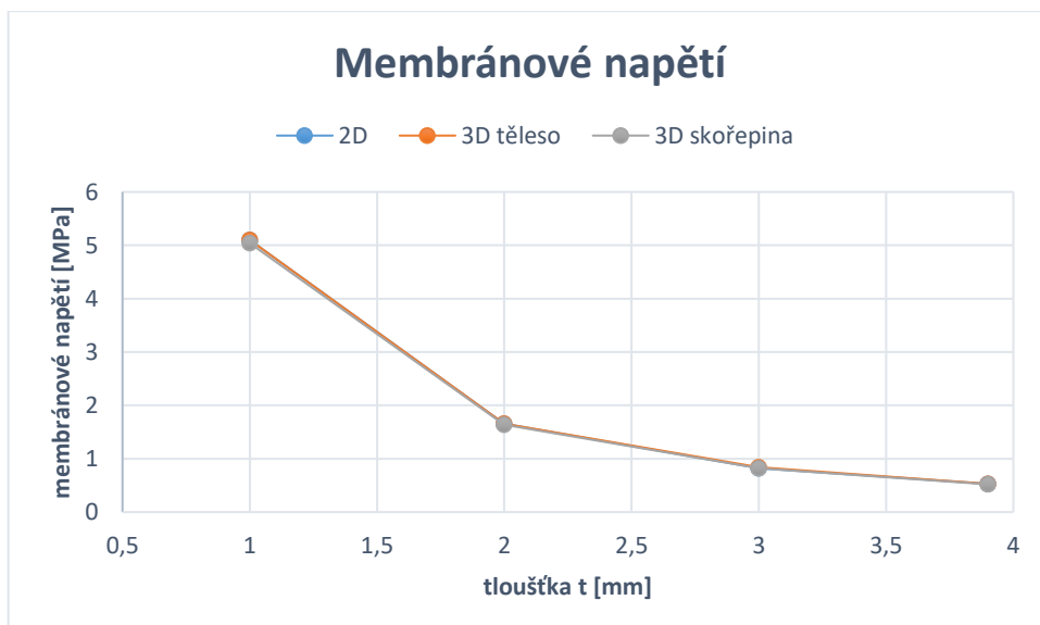
Obr. 7.34: Graf závislosti velikosti membránového napětí \sigma_m [MPa] na tloušťce t [mm] pro tři řešení: 2D, 3D těleso a 3D skořepinu. Hodnoty jsou uvedeny v příloze tabulka 6
