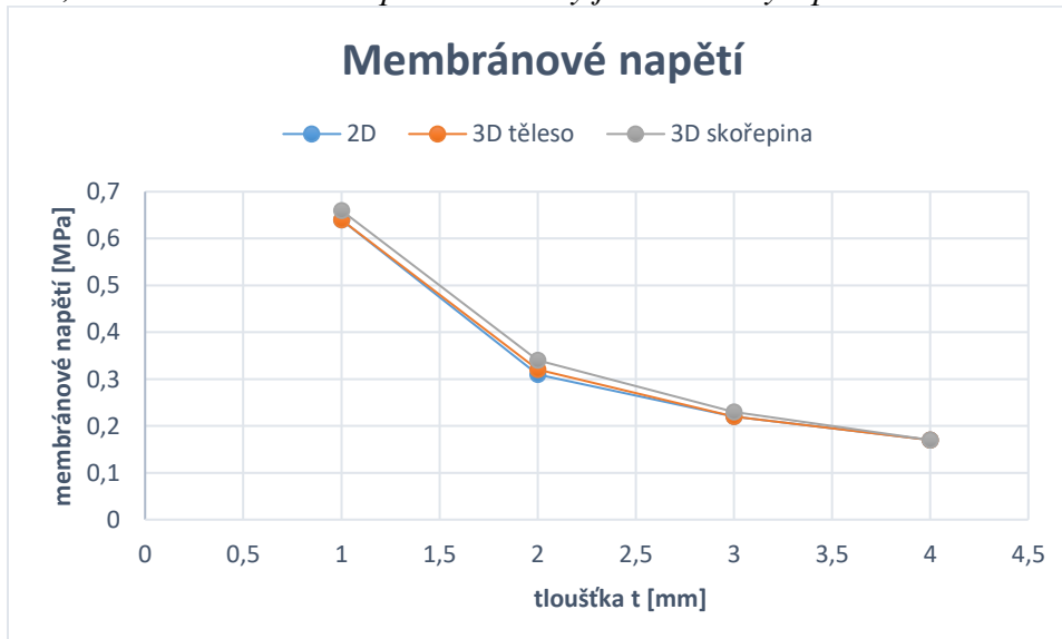
Obr. 7.17: Graf závislosti velikosti membránového napětí \sigma_m [MPa] na tloušťce t [mm] pro tři řešené úlohy: 2D, 3D těleso a 3D skořepinu. Hodnoty viz příloha tabulka 2
