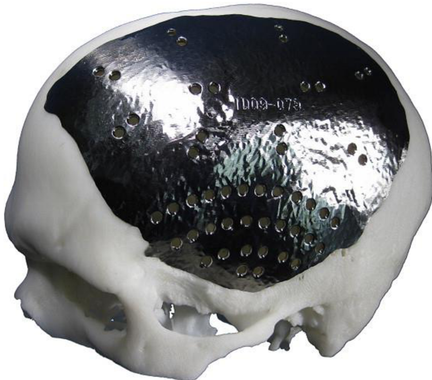
Obr. 5.1: Příklad personalizovaného implantátu ze slitiny titanu [28]
