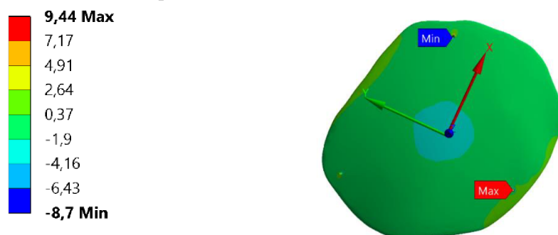
Obr. 7.38: Normálové napětí implantátu s označeným minimem a maximem
