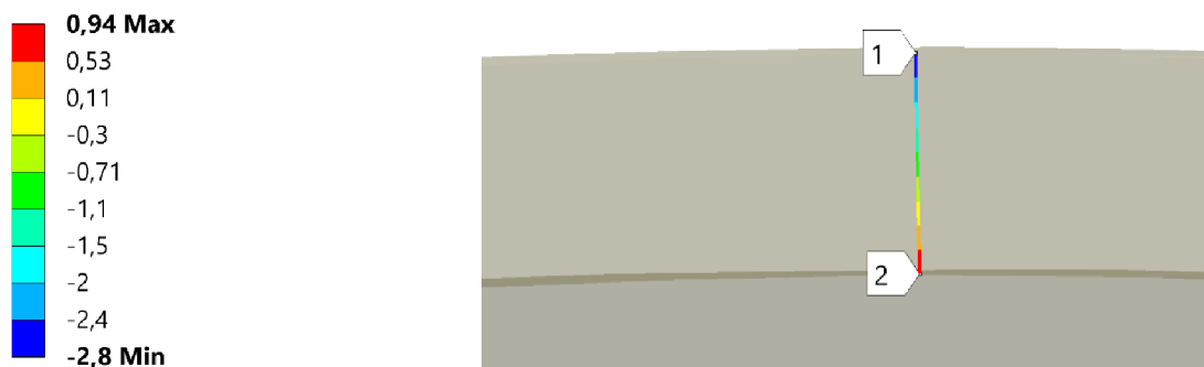
Obr. 7.39: Detail průběhu normálového napětí po tloušťce implantátu v centru oblasti zatížené vnější silou [MPa], jednotlivá napětí v bodech 1 a 2 jsou popsány v tabulce 7.3
