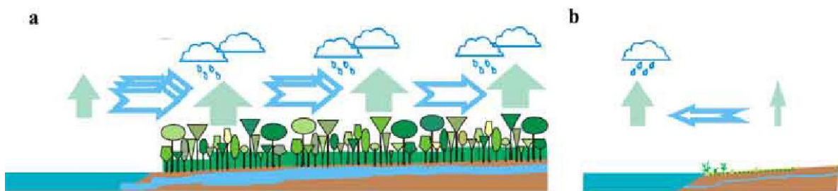
Obr. č. 4: Znárodnění a) fungující biotické pumpy transportující vlhkost na kontinent; b) narušení mechanismu biotické pumpy (Makarieva a Gorshkov, 2010).
