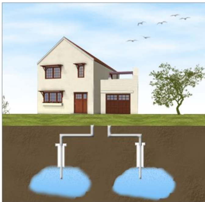
Obr. 11 - Čerpací a vsakovací studna u TČ voda-voda
