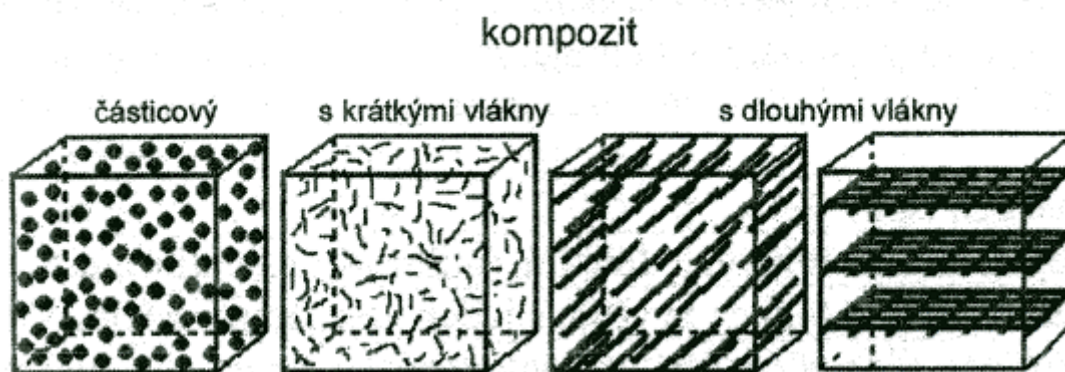
Obr. 2: Rozdělení kompozitních materiálů podle geometrického tvaru výztuže. [1]
