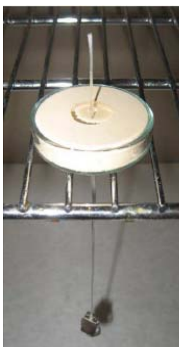
Obr. 13: Příprava polymerního tělíska na svazku skleněných vláken
