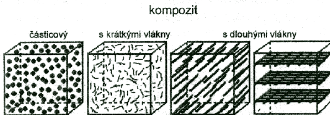
Obr. 2: Rozdělení kompozitních materiálů podle geometrického tvaru výztuže. [1]
