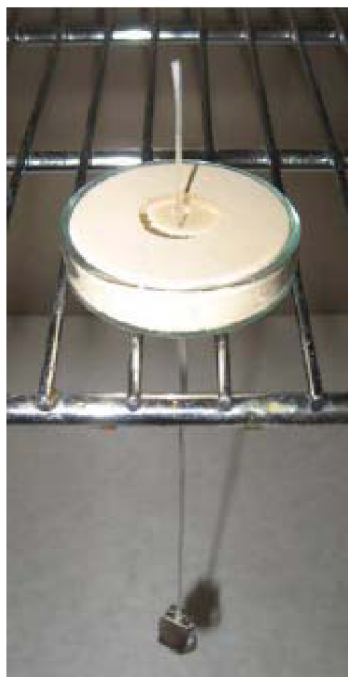
Obr. 13: Příprava polymerního tělíska na svazku skleněných vláken
