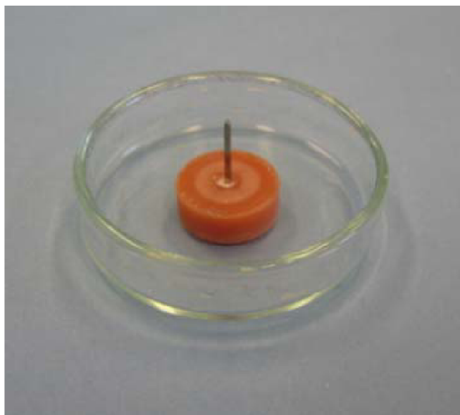
Obr. 15: Forma na výrobu polymerního tělíska (disku)
