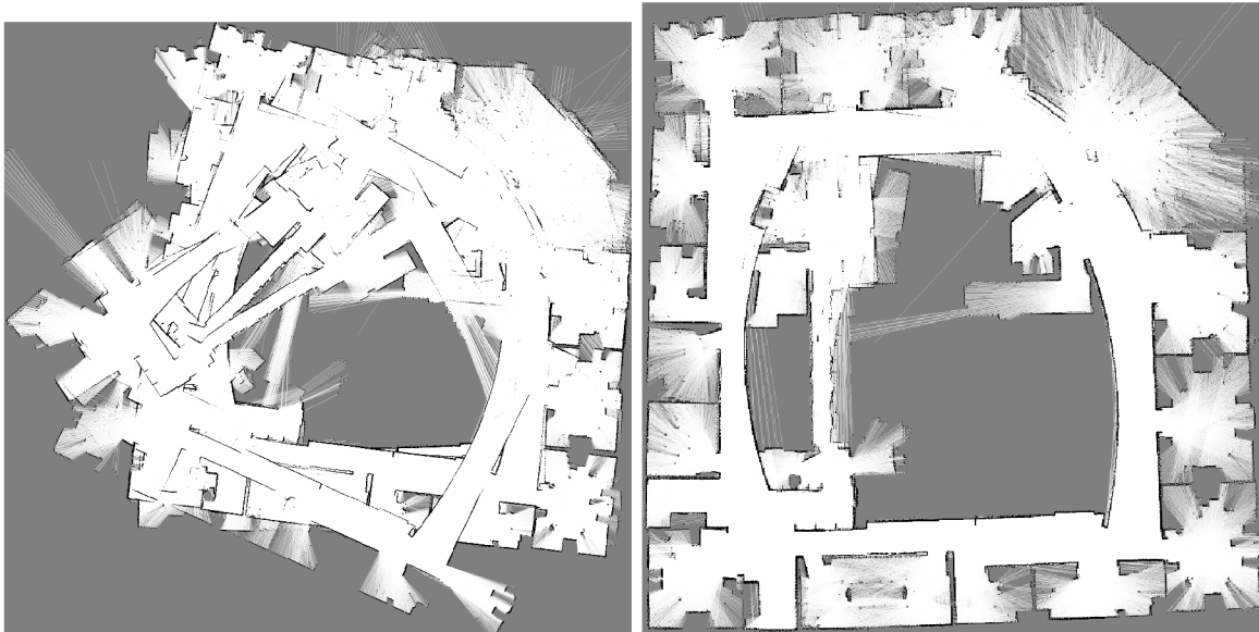
Obrázek 7.1: Srovnání kvality výsledné mapy při rozdílném nastavení frekvence mapování. Oba obrázky byly vygenerovány s použitím pouze jedné částice. Úspěch algoritmu je tak zcela závislý na kvalitě predikce (odhadu pozice). Obrázek vlevo zobrazuje mapu vytvořenou s mapováním v každé iteraci. Druhý obrázek byl vytvořen s mapováním pouze v každé páté iteraci ( n = 5 ). Z tohoto obrázku je již jasně patrné, jak zhruba mapované prostředí vypadá. Rozlišení map je 4\text{cm}^2 .
