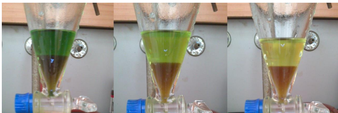
Obrázek 14: Postupné ubývání zeleného barviva (chlorofylu) v horní frakci v dělicí nálevce
