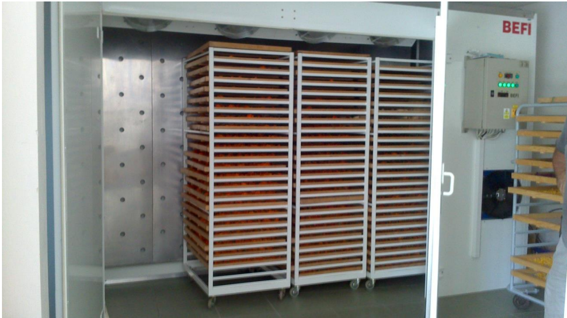
Obrázek 10: Nízkotepečná rekuperační sušička
