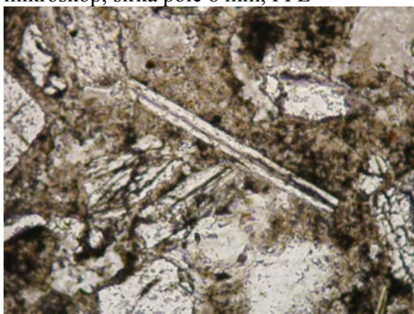
Obr. 37a: Pískovec s kaolinickým pojivem a klasty slíd. Vzorek VS4, šířka pole 8 mm, PPL
