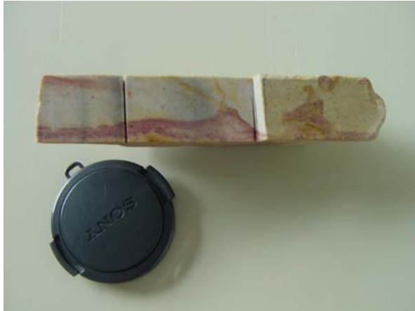
Obr. 13: Maletínský pískovec (Kubitschekův lom) s fialovočerveně zbarvenými smouhami (vtroušený hematit).
