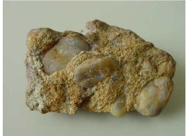
Obr. 14: Slepenecký pískovec z nadloží maletínského pískovce, Kubitschekův lom. Šířka snímku 5,5 cm
