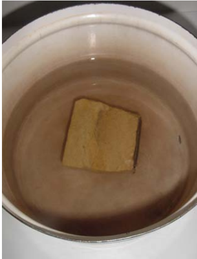
Obr. 39: Stanovení nasákavosti a objemové hmotnosti – metoda s nasakováním 24 hod
