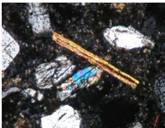
Obr. 37b: Pískovec s kaolinickým pojivem a klasty slíd. Vzorek VS4, šířka pole 8 mm, XPL
