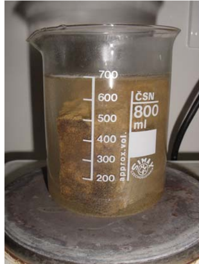
Obr. 40: Stanovení nasákavosti a objemové hmotnosti – metoda s povařením
