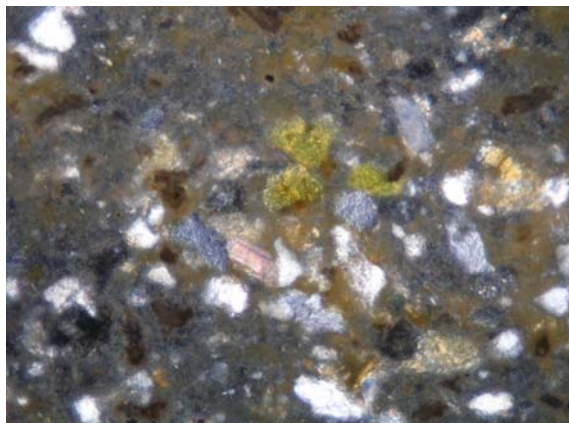
Obr. 36b: Pískovec s autigenním glaukonitem. Vzorek VS2, optický mikroskop, šířka pole 8 mm, XPL
