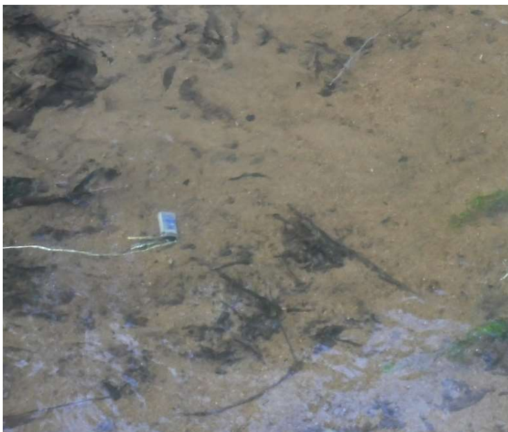
Obrázek 4. 3 Sada teploměrů umístěných v substrátu dna tak, aby byl teploměr nejbližší hřebíku v hloubce 10 cm, prostřední v hloubce 3 cm a horní teploměr v úrovni nade dnem pro zaznamenávání teploty volné vody (foto Vojtěch Barák).
