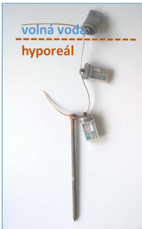
Obrázek 4. 2 Sada tří teploměrů HOBO PENDANT připevněna k železnému hřebíku o délce 20 cm pomocí ocelového lanka (foto Václava Jahelková).
