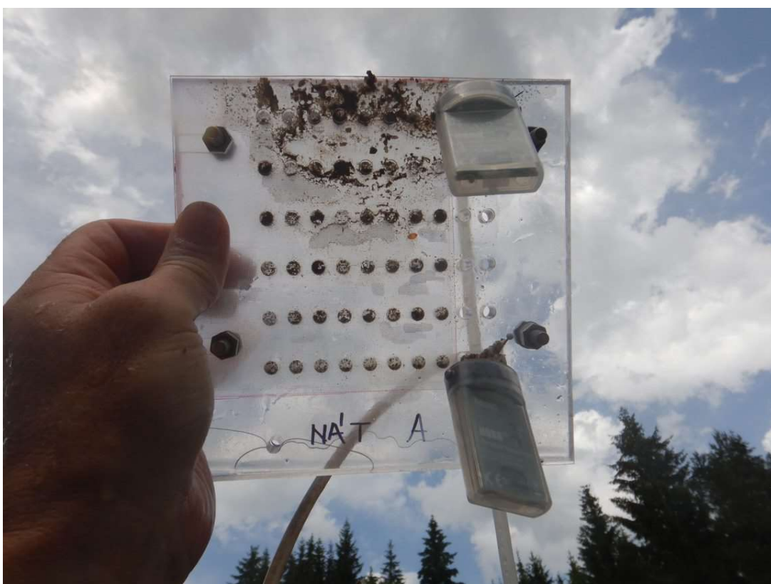
Obrázek 4. 4 Upravená Buddensiekova destička s juvenilními jedinci v zasítovaných otvorech. Na destičce jsou přichyceny dva záznamové teploměry HOBO Pedant (při instalaci ve dně umístěných v hloubkách 3 a 7 cm) (foto Ondřej Simon).
