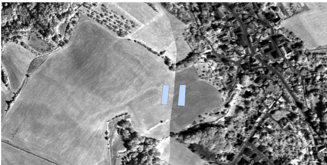
Obr. 18: Umístění polygonů pro zjištění rozdílu v odrazivosti mezi letovými liniemi č.6 a č.7 v pásmu č.44. S obrázkem souvisí Graf 1.
