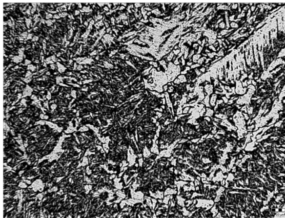
Obr. 5.1.1.8 Pásmo přehřátí (TOO) + svarový kov
