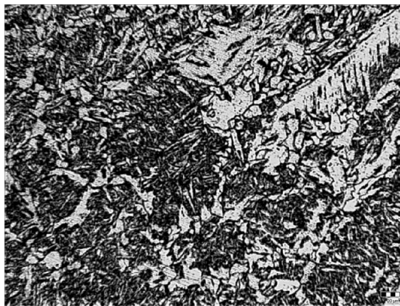
Obr. 5.1.1.8 Pásmo přehřátí (TOO) + svarový kov
