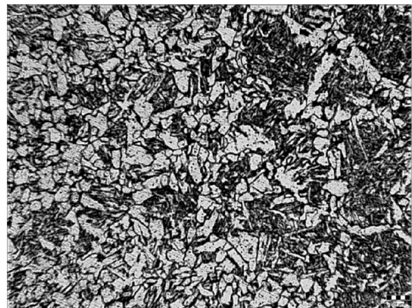
Obr. 5.1.1.7 Pásmo normalizace (TOO) + Ac_3 (vlevo) a pásmo přehřátí (TOO) + pásmo normalizace (vpravo)
