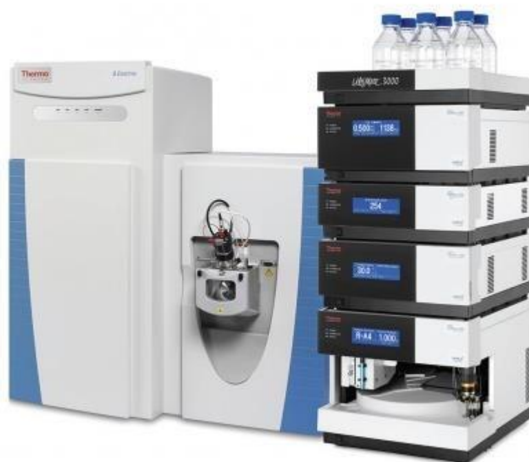
Obr. 12 Sestava chromatografu s hmotnostním spektrometrem použitým při analýze. Převzato z internetu [42].
