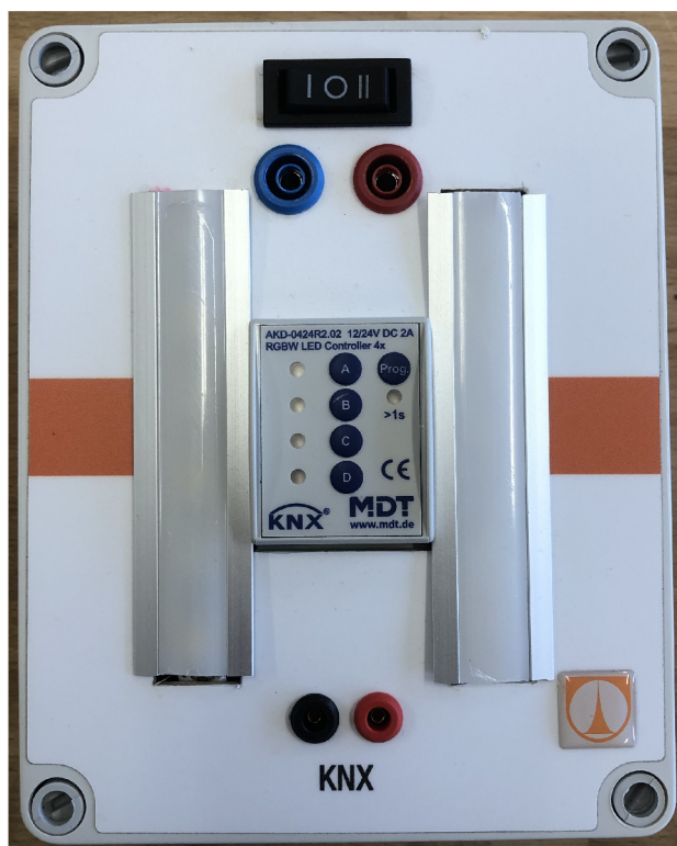
Obrázek 5.5: Modul s LED pásky, 1. typ
