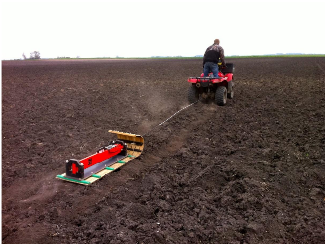
Obrázek 19 - Měření půdy přístrojem EM38 taženým za terénní čtyřkolkou
