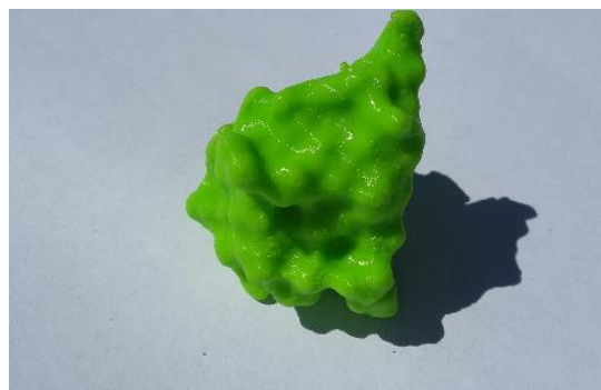
Obrázek 18 - Molekula hormonu - inzulínu, vytištěného ze zeleného ABS materiálu po úpravě acetonem
