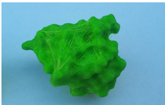
Obrázek 20 - Molekula hormonu - inzulínu, vytištěného ze zeleného PETG materiálu, na obrázku jsou vidět zbytky filamentu vzniklé při pohybech extrudéru.
