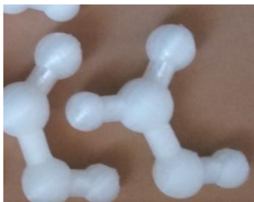
Obrázek 27 - Trojrozměrný model kyseliny mravenčí po odstranění podpěr bezprostředně po tisku.
