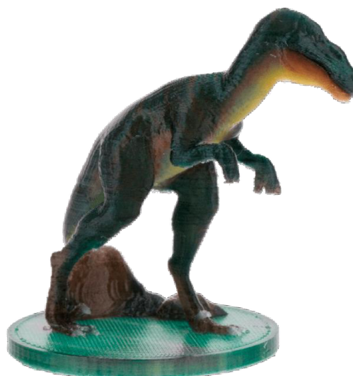
Obrázek 24 - Model vytištěný na 3D tiskárně Da Vinci Color firmy XYZ printing. K obarvení plastu používá barevný inkoust [49].
