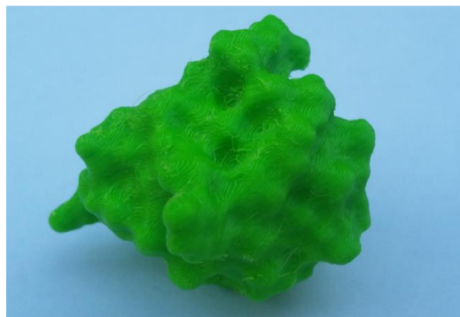
Obrázek 21 - Stejný model jako na obrázku 20 po odstranění „vlásků“.
