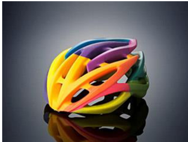
Obrázek 23 - Předmět vyrobený vícebarevným tiskem na 3D tiskárně Stratasys Objet500 Connex3 Color [49].
