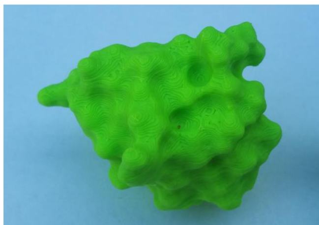
Obrázek 15 - Molekula hormonu - inzulínu, vytištěného ze zeleného PLA materiálu.
