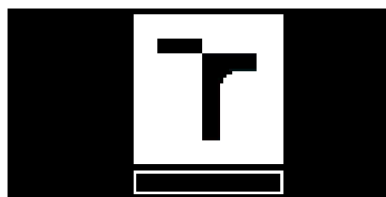
Obr. 5.7: Startovní obrazovka OLED displeje, kde bílá značí rozsvícený pixel.
