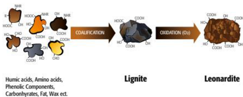
Obrázek 1: Proces oxidace uhlí (upraveno podle Humintech GmbH, 2015).
