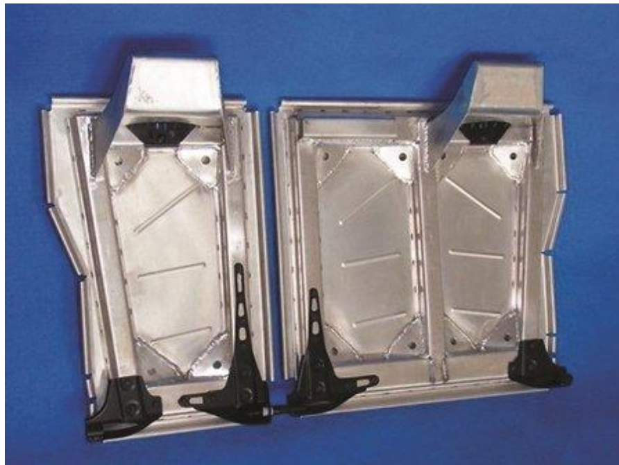
Obr. 2.7 Opěradlo vyvinuté pro BMW-M GmbH. [15]
