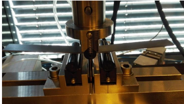
Obr. 3.3 Měření vzorku zkouškou ohybem
