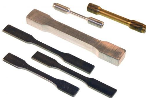
Obr. 1.1 Zkušební tyče (zkouška tahem) [1]
