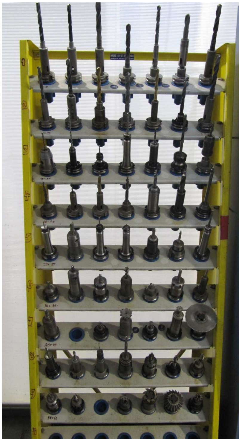
Obrázek 4.1: Redukovaný stojan na speciální nástroje [1]
