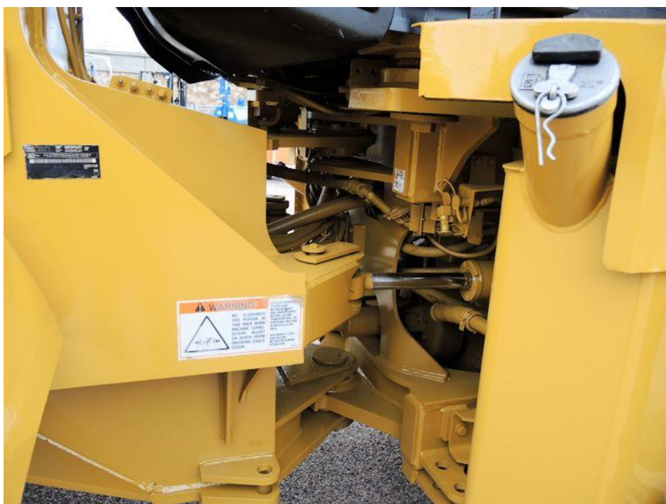
Obr. 10 Detail kloubového řízení nakladače Cat 950G [20]
