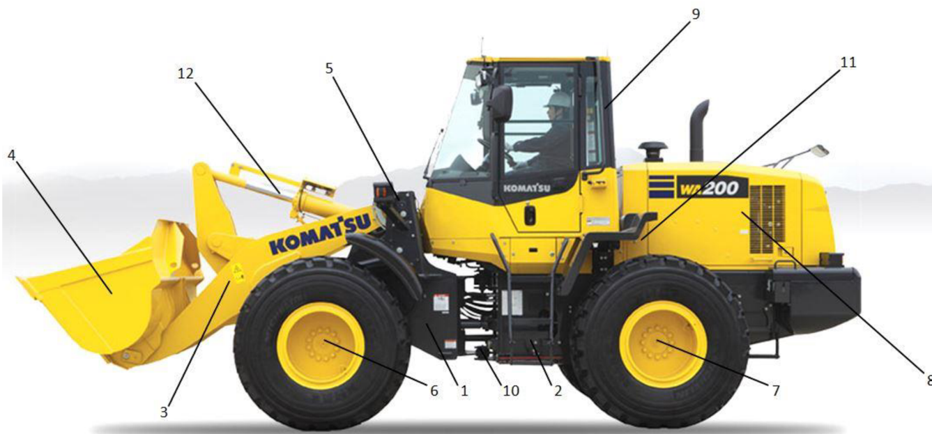
Obr. 3 Konstrukční provedení kloubového nakladače Komatsu WA200-7: 1 - přední rám, 2 - zadní rám, 3 - výložník, 4 - nabírací lopata, 5 - čep uložení výložníku v rámu, 6 - přední náprava, 7 - zadní náprava, 8 - prostor uložení motorové jednotky, 9 - kabina, 10 - kloubové spojení rámu (ložisko), 11 - prostor uložení hydroměniče, převodovky a hydraulického zařízení, 12 - hydraulický píst zavírání lopaty [1][5]
