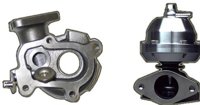
Obr. 38 Interní a externí wastegate [14]
