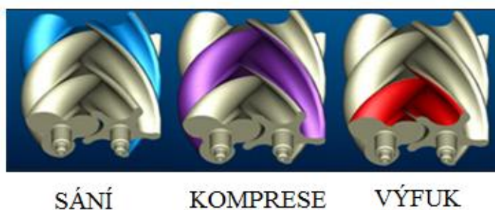
Obr. 29 Lysholmův kompresor - princip stlačení vzduchu [25]
