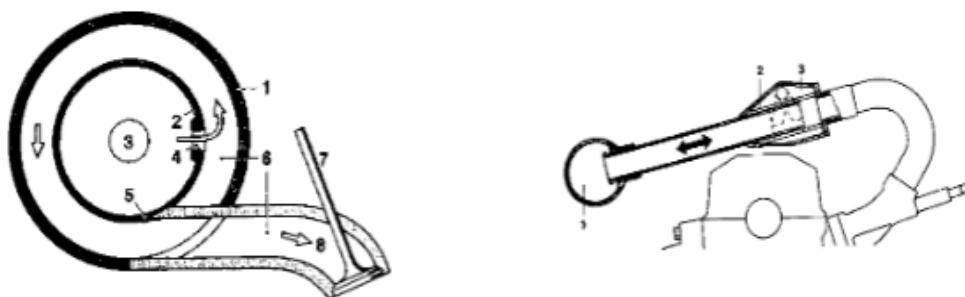
Obr. 15 Radiální a přímý systém změny délky sacího potrubí [7]
