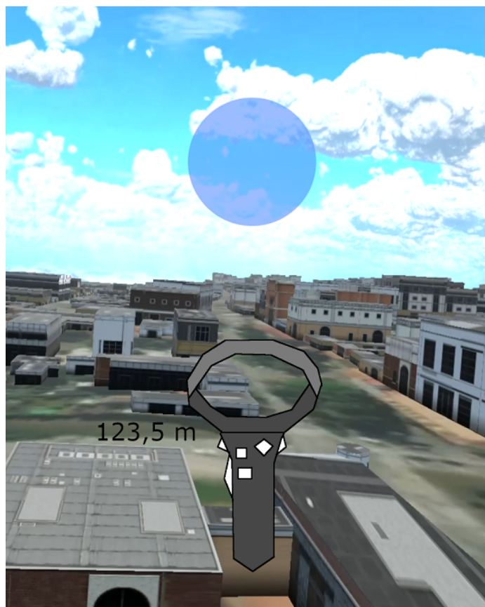
Obrázek 4.7: Pohyb pomocí teleportace, kde modrá koule vizualizuje pozici pro teleportaci, číselný údaj u kontroléru pak vzdálenost této pozice od uživatele.
