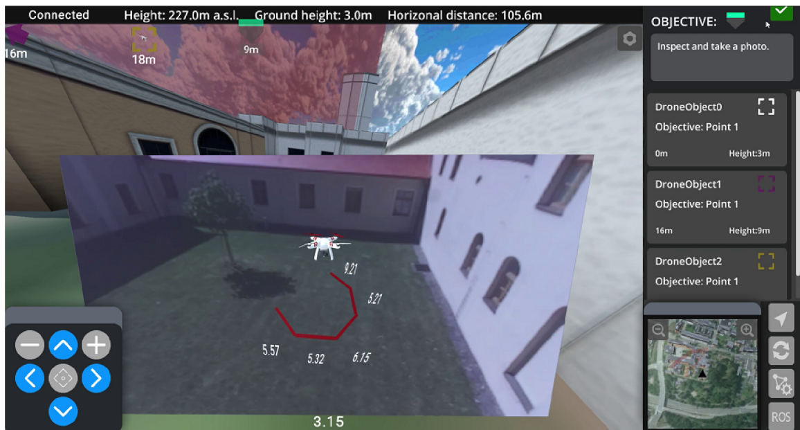
Obrázek 4.1: Ukázka rozšířené virtuality v DroCo. Reprezentace dronu a jeho okolí ve virtuální scéně spolu s videem z dronu. 2
