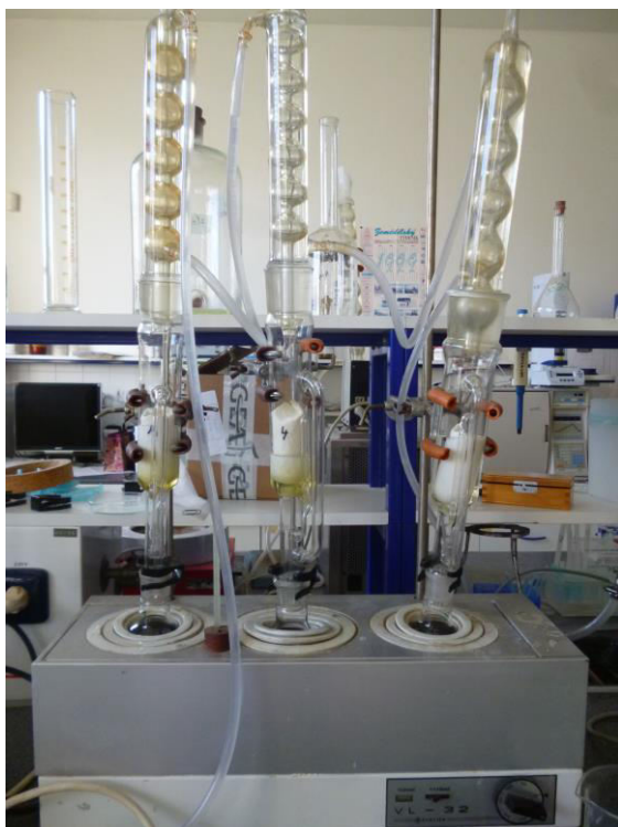
Příloha 21 Extrakční přístroj s elektrickým vaříčem VL-32 AVALIER (foto Šindelářová)
