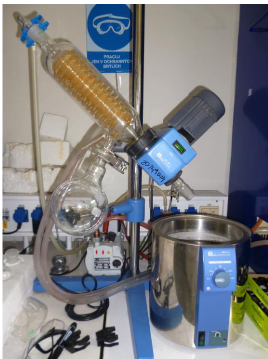
Příloha 22 Vakuová rotační odparka HB4 basic (KIKA Labortechnik) (foto Šindelářová)
