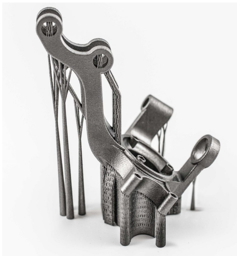
Obr. 57 Příklad struktur podpěr pro aditivní výrobu SLM (vlevo stromečková, vpravo mřížková). Převzato z [46]
