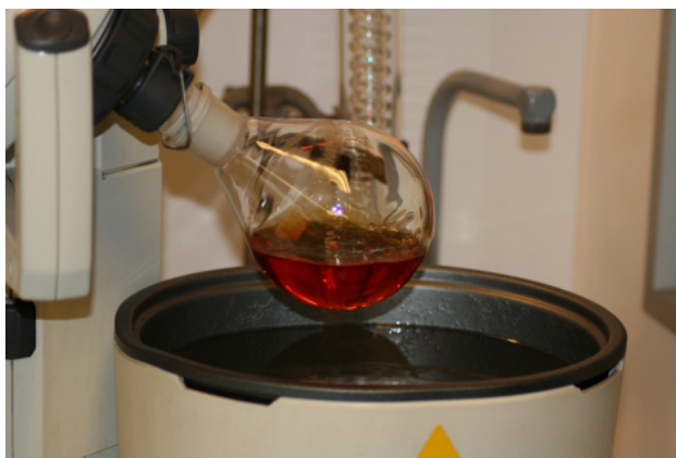
Obr. 9.: Probíhající syntéza nanokoloidu oxidu zinku dopovaného 5% Fe 3+ .
