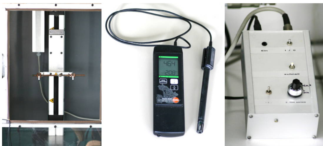
Obr. 11.: Dip-coater, kontrola vlhkosti a teploty, ovládací panel rychlosti a směru pohybu ramene dip-coateru.
