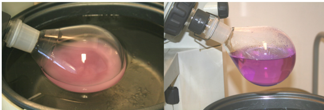
Obr. 10.: Syntéza oxidu zinku dopovaného 5% Co 2+ na začátku procesu (vlevo) a před kondenzací LiOH (vpravo).
