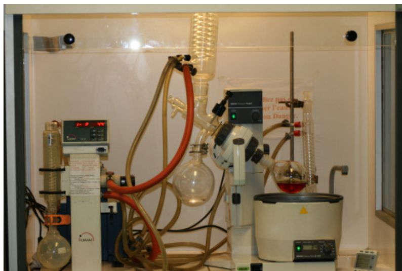
Obr. 6.: Aparatura Rotavapor k přípravě a koncentraci nanokoloidních roztoků.
