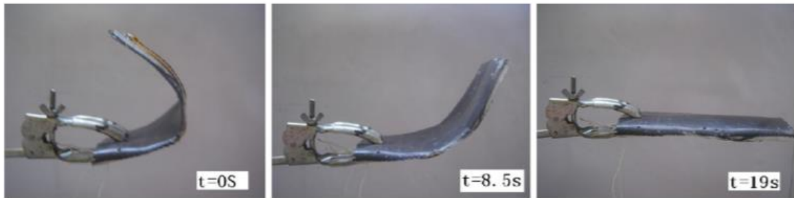
Obrázek 2.2.7 Rozvinutí kompozitu, tvořeného polymerem s tvarovou pamětí [3]
